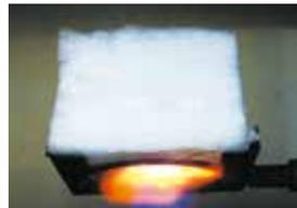
発泡プラスチック系の断熱材
